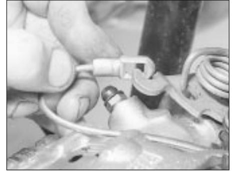
11.5a Unhook the handbrake cable . . .
