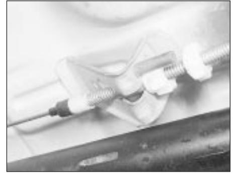
**22.3 Handbrake cable adjuster**
